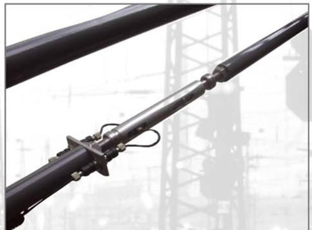
Auslösemechanismus des ADD-Systems Respond mechanism of the ADD-System
